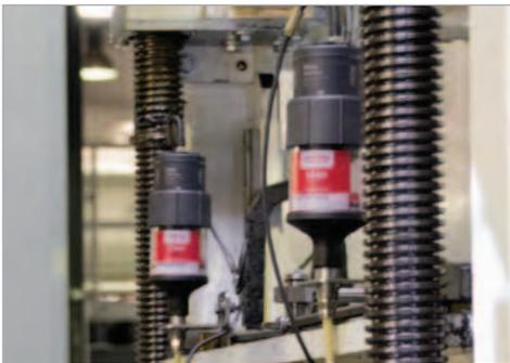
Para alargar la vida útil y la disponibilidad de las transmisiones de coronas dentadas, la relubricación es un proceso de especial relevancia. Ya al comienzo de una fase de entrada debe observarse que la superficie de los flancos de los dientes se alisa.
